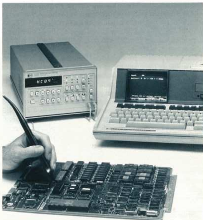
Met dit foutanalysesysteem voor bedradingen kunt u het controleren en herstellen van digitale schakelingen voor een groot deel automatiseren.
