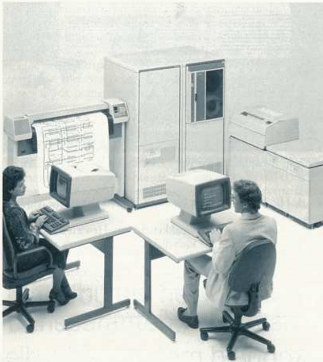
De A900-computer verwerkt 3 miljoen instructies per seconde voor allerlei veeleisende wetenschappelijke en technische toepassingen.
