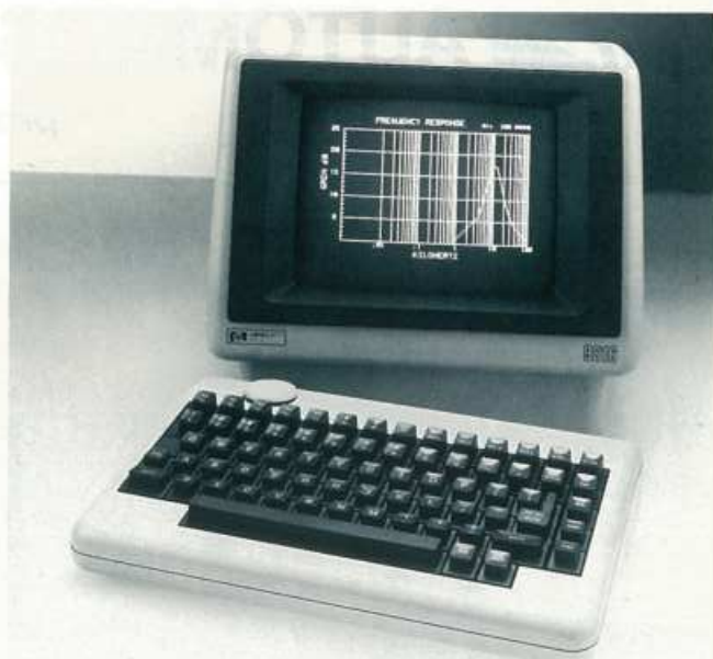
Model 16 is een personal computer met ingebouwde grafische verwerking en een speciale draaiknop voor editen, cursorbesturing en grafische invoer.
